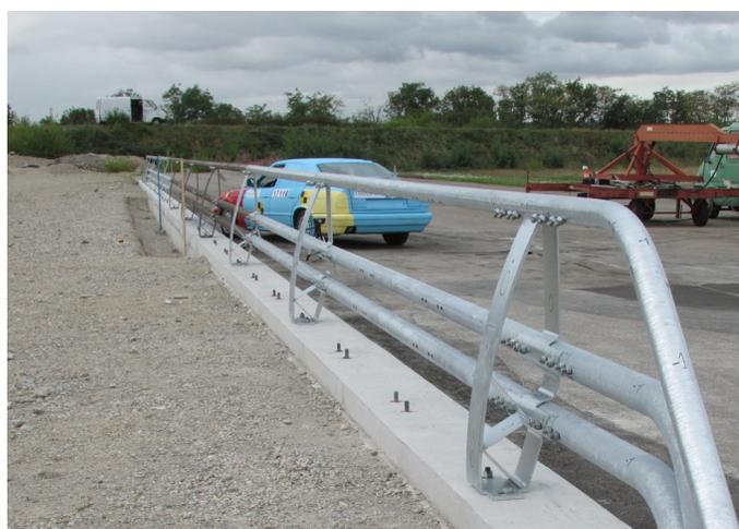
Système fusible permettant de réutiliser les ancrages après un impact
